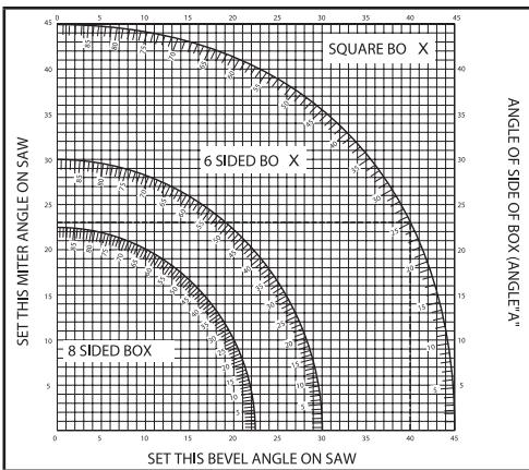
◆ Dit schema helpt u bij het kiezen van de juiste afschuinhoek en instellingen van het verstek voor veelgebruikte samengestelde verstekzaagsneden. Selecteer de gewenste hoek 'A' (Afb. 32) van uw project en zoek deze hoek op de bijbehorende parabool in het schema.
