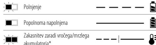
\*Rdeča lučka še naprej utripa, rumena lučka pa sveti neprekinitljivo med ogrevanjem ali ohlajanjem akumulatorja. Ko akumulator doseže ustrezno temperaturo, rumena lučka ugasne, polnilnik pa nadaljuje s polnjenjem.
