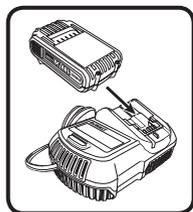
いつものような仕事をさせたときに工具が力強く作動しない場合は絶対に使用せず、再充電してください。以前に少しだけ使用した充電電池も、ご使用前に再充電することを心がけてください。
