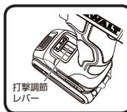
打撃調節レバーで3段階（1弱－2中－3強）に打撃力の調節が出来ます。ご使用前に用途に合わせて調節ください。
