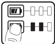
DCB182 : 18V4.0Ahリチウム電池にはバッテリー残量ゲージが着いています。バッテリーマークのボタンを押すことにより、バッテリー残量を3段階に表示します。
