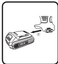
充電電池を工具から取り外すとき、充電電池の前面にあるリリース・ボタンを押したまま、充電電池を前方に引き出すと工具から外れます。
