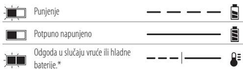
\*Crveno svjetlo nastaviti će treperiti, no žuta indikatorska lampica ravnomjerno će svijetliti kada je ova funkcija aktivna. Kada baterija postigne odgovarajuću temperaturu, žuta lampica će se isključiti, a punjač će nastaviti s punjenjem.
