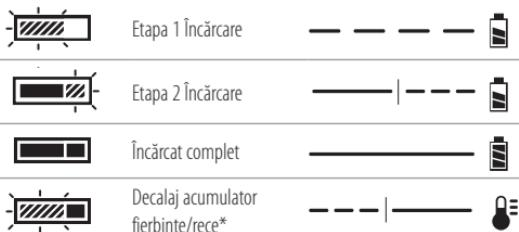
\*Indicatorul luminos roșu se va aprinde intermitent continuu, dar rămâne aprins un indicator luminos galben în timpul acestei operații. După ce acumulatorul a atins o temperatură corespunzătoare, indicatorul luminos galben se stinge și încărcătorul reia procedura de încărcare.
