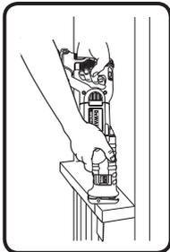
ソー・ブレードを従来の逆向きに装着することにより床や隅、困難な角度等も切断作業が容易に可能です。
