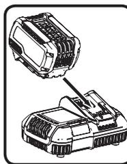
いつものような仕事をさせたときに工具が力強く作動しない場合は絶対に使用せず、再充電してください。以前に少しだけ使用した充電電池も、ご使用前に再充電することを心がけてください。
