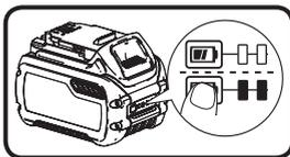
電池のマークを押すことにより、電池残量の確認が行えます。点灯数により電池残量の目安にしています。
