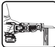
木材が固定されていないときは、切断作業の前にならずクランプ等を使って加工する物を固定してください。まずソー・ブレードをゆっくりと加工物へおろし、モーターのスイッチをゆっくり入れ、切断を開始する前に速度を最大まで上げてください。切断作業の最中はかならず両手を使ってレシプロソーをしっかりと固定してください。振動やぶれを防止するため、ブレード・ガードは作業物に常に接触した状態を保ってください。ソー・ブレードの破損防止にもつながります。
