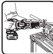
ソー・ブレードの種類により、金属の切断能力は異なります。ソー・ブレードを選ばれるとき製品の仕様、用途をよく読み、作業の内容に適したブレードをお選びください。通常、歯数が多いブレードの方がきれいに仕上がります。薄い金属板を切断される際、金属板の両面を木材ではさみ、クランプで固定することをお勧めします。この方が振動や金属切断部のまくれを防止し、きれいに仕上がります。切断作業中、無理な力をかけて切断することはソー・ブレードの寿命を著しく短縮させますのでおやめください。
