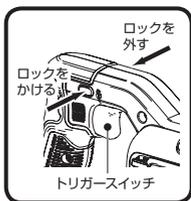
図にあるよう、安全ロック・ボタンを解除してください。トリガースイッチを引くとモーターに電源が入ります。トリガースイッチをはなすと電源が切れます。トリガースイッチには無段変速機能が組み込まれていますので、深く引くと高速、浅く引くと低速と速度を調節することが可能です。作業の用途により、トリガースイッチの引き具合で速度を調節できます。
