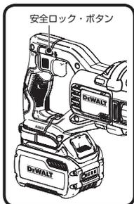
このレシプロソーのスイッチには安全ロック・ボタンが付いています。(左図を参照ください。) この工具を持ち運ぶ際や保管する際、急に作動して事故を引き起こすのを防止するため、必ず安全ロック・ボタンをかけた状態にしてください。
