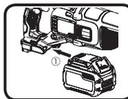
充電電池を本機に取り付けるとき、充電電池の向きが工具ハンドル部分下にある挿入口と合っていることを確認し、「カチン」としっかりはまるまで電池を差し込んでください。
