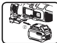
充電電池を工具から取り外すとき、充電電池の前面にあるリリース・ボタンを押したまま、充電電池を下に引きますと工具から外れます。
