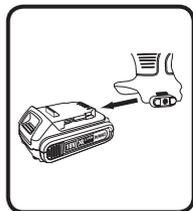
充電電池を工具から取り外すとき、充電電池の前面にあるリリース・ボタンを押したまま、充電電池を下に引きますと工具から外れます。
