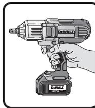
左図のように、トリガー（引き金）スイッチを引くと作動します。またトリガースイッチを放せば止まります。トリガースイッチには無段変速機能が組み込まれていますので、強く引くと高速、弱く引くと低速というように速度を調節できます。作業の内容によってトリガーの引き具合で速度を調節できるので大変便利です。
