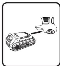
充電電池を本機に取り付けるとき、充電電池の向きが工具ハンドル部分下にある挿入口と合っていることを確認し、「カチン」としっかりとまるまで電池を差し込んでください。
