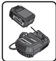
いつものような仕事をさせたときに工具が力強く作動しない場合は絶対に使用せず、再充電してください。以前に少くだけ使用した充電電池も、ご使用前に再充電することを心がけてください。
