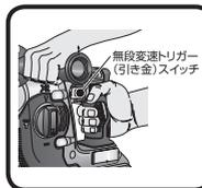
トリガー（引き金）スイッチを引くと作動します。またトリガー（引き金）スイッチを放せば止まります。トリガースイッチには無段変速機能が組み込まれていますので、深く引くと高速、浅く引くと低速というように速度を調節できます。作業の内容によってトリガーの引き具合で速度を調節できるので大変便利です。
