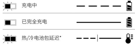
\*红色指示灯会继续闪烁, 但黄色指示灯在本次操作过程中会亮起。电池包达到适当温度后, 黄色指示灯会熄灭, 充电器将恢复充电程序。
