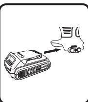
充電池を本機に取り付けるとき、充電池の向きが工具ハンドル部分下にある挿入口と合っていることを確認し、「カチン」としっかりとまるとまで電池を差し込んでください。
