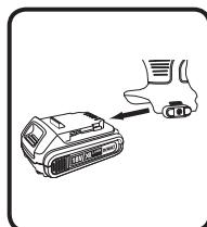
充電池を工具から取り外すとき、充電池の前面にあるリリース・ボタンを押したまま、充電池を下に引きますと工具から外れます。
