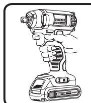
左図のように、トリガー（引き金）スイッチを引くと作動します。またトリガースイッチを放せば止まります。トリガースイッチには無段変速機能が組み込まれていますので、強く引くと高速、弱く引くと低速というように速度を調節できます。作業の内容によってトリガーの引き具合で速度を調節できるので大変便利です。
