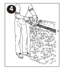
4. 修剪籬笆側邊(圖 7)-如圖所示握住修剪器,由下開始往上掃。
