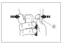
左図のように、正転/ロック/逆転スイッチ(④)を工具左側にスライドさせると正転し、工具右側にスライドさせると逆転します。このスイッチを中央位置にセットしておくと、トリガースイッチがロックされて動かなくなります。使用しないときは、ロックをかけた状態にしておいてください。
