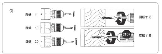
太いネジには高いトルク設定が必要ですが、細いネジにはあまり高いトルクはかえってネジを痛めます。何本かのネジ締めをする時に、最初の一本目でネジの頭が板とピッタリ平面になるところで回転が止まるようなトルクを見つけてそのトルクに設定しますと、二本目以後のネジ締めで平面を出すのが容易になります。
