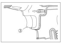
トリガースイッチ(③)を引くと作動します。またトリガースイッチを放せば止まります。トリガースイッチには無段変速機能が組み込まれていますので、深く引くと高速、浅く引くと低速というように速度を調節できます。作業の内容によってトリガーの引き具合で速度を調節できるので大変便利です。
