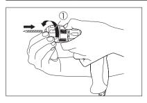
(1) 本機にはキーレスチャック(①) が装備されています。一方の手でチャックカバー後半部を持ち、もう一方の手で前半部を時計の針と反対方向に回してチャックを開いてください。使用するビットを開いたチャックの中に20ミリ程度押し込んでください。
