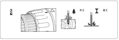
深くネジを埋め込む作業や穴開け作業には、24段階目のクラッチポジション"2"の位置にクラッチをセットしてください。この位置ではトルク調整装置が作動しません。
