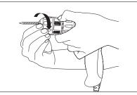
(2) 一方の手でチャックカバーの後半部を持ち、もう一方の手で時計の針と同じ方向に前半部を回してキーレスチャックを締めてください。作業が終わったら、再びチャックカバーを時計の針と逆方向に回し、ビットを取り外してください。
