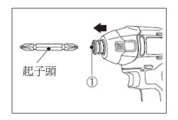
安裝起子頭時,請朝箭頭方向拉出快速夾頭(①)的同時插入起 子頭。插入底部後,手鬆開套筒以固定起子頭。
