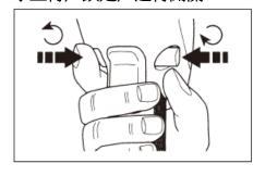
從左圖方向來看,朝左側將正轉/鎖定/逆轉開關(⑤)推到底 即為正轉。從右側將開關推到底則為逆轉。將此開關設定於中 央位置後,即鎖定觸動開關而無法再運作。不使用時,請設定 為鎖定狀態。變更此開關位置時,請務必放開觸動開關。
