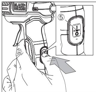
(1) 充電池を本製品から取り外す前に、ON/OFFスイッチ (5) の「0」の部分を押し、電源がオフになっていることを確認してください。
