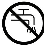
Според важечките прописи, апаратот никогаш не смее да се користи на мрежата за вода за пиење без сепаратор на системот. Користете сепаратор според IEC 61770 Тип ВА.
