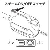
電源プラグをコンセントに差し込み、本体の側面にあるメインスイッチ(黒色)をONにしてください。約20秒で内部のボイラーが温まりスタンバイが完了します。次に本体ハンドル部分のスチームON/OFFスイッチをONにしてください。
