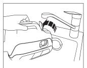
タンクキャップを外して水を給水タンクに注いでください。 給水タンクの容量は100mlです。それ以上の水を注がないでくだ さい。給水が終わったら必ずタンクキャンプを閉めてください。 水を注ぐ際は電源コードを束ねるなどして水にぬれないようにし てください。使用前に水滴等をふきとってください。 給水タンクの水量をこまめに確認するようにしてください。
