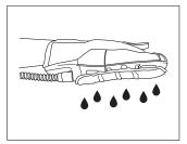
内部のボイラーが十分に温まっていない状態でスチームON/OFF スイッチをONにすると水がそのままスチームミット部分から出 る場合があります。
