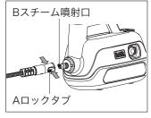
左図のように、ホースのAロックタブを左右両方から押しながら本体のBスチーム噴射口の奥まで差し込んでください。奥まで差し込んだらロックタブを離してください。
