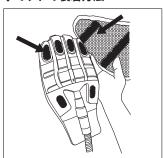
ミット裏面に合わせてマイクロファイバーパッドを装着してください。その際、ミット上部からパッドを合わせるように貼り付け、ミットとマイクロファイバーパッドの面ファスナーがしっかり重なっていることを確認してください。
