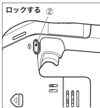
(3) 製品を使い終わった時、使用していない時は誤作動を防止するため、必ず左のイラストの方向（鍵が閉まっているマークがある側）からロックボタン (②) を押しこみ、ロックをしてください。
