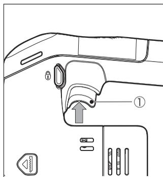
(2) ロックを解除した状態で無段変速トリガースイッチ (①) を矢印の方向に引くと作動します。また無段変速トリガースイッチを放せば止まります。無段変速トリガースイッチは、トリガーの引き加減でストローク数を0～2,800回/分に調節することができます。トリガーをいっぱいに引いた状態で最大ストローク数となります。
