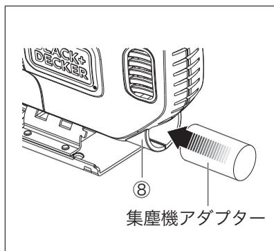
本機は付属の集塵機アダプターを使用し、集塵機に接続して使用することができます。
