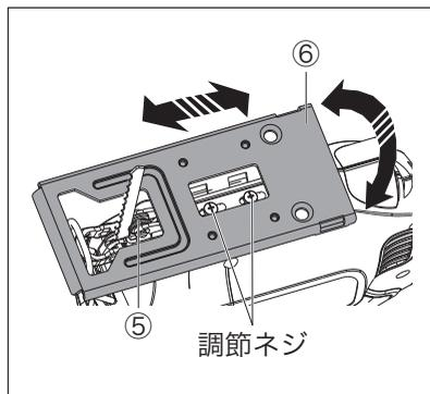
ベースプレート (⑥) の裏側にある調節ネジをマイナドライバーでゆるめることでベースプレートの斜角調整を行うことができます。
