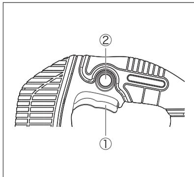
無段変速トリガースイッチ(①)を引くと作動します。また無段変速トリガースイッチを放せば止ります。無段変速トリガースイッチを引いた状態でスイッチ・ロックボタン(②)を押すと、無段変速トリガースイッチがロックされ継続的に使用するとき便利です。ロックを解除するには、トリガースイッチをもう一度軽く引いてください。
