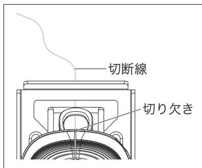
切断する材料に鉛筆等で切断線を書き、図のように本機を切断線の上に配置します。
