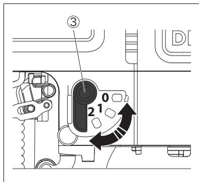
KS701PEは切断する材質の特性や作業内容に合わせ3段階にオービタル機構を調節することができます。硬い材質の物を切断するとき、もしくは細かい切断、精度の必要な作業を行うときはオービタル調節スイッチ（③）を0あるいは1の位置にしてください。柔らかい材質の物を切断するとき、もしくは速い切断（荒切り）作業をする場合は、スイッチを2あるいは3の位置にしてください。
