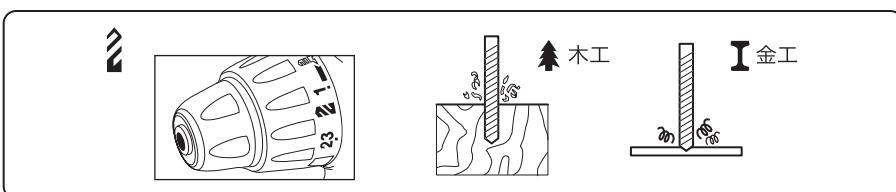
穴あけ作業には、24段階目のクラッチポジション“3”的位置にクラッチをセットしてください。この位置ではトルク調整装置が作動しません。
