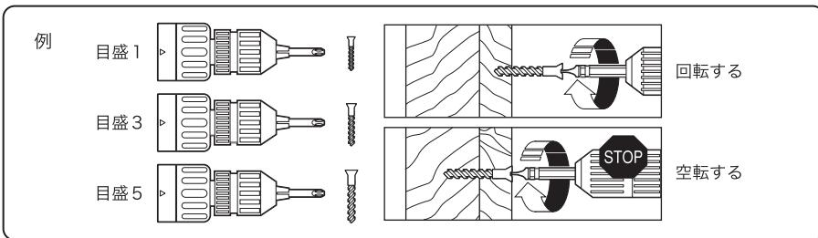
太いネジには高いトルク設定が必要ですが、細いネジにはあまり高いトルクはかえってネジを痛めます。何本かのネジ締めをする時に、最初の一本目でネジの頭が板とピッタリ平面になるところで回転が止まるようなトルクを見つけてそのトルクに設定しますと、二本目以後のネジ締めで平面を出すのが容易になります。加工面を保護するためには、低いトルクで作業を開始してください。
