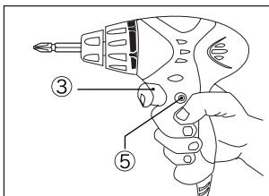
左図のように、トリガースイッチ(③)を引くと作動します。またトリガースイッチを放せば止まります。トリガースイッチには無段変速機能が組み込まれていますので、強く引くと高速、弱く引くと低速というように速度を調節できます。作業の内容によってトリガーの引き具合で速度を調節できるので大変便利です。
