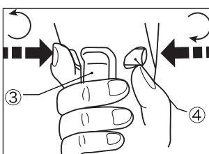
左図のように、正転／ロック／逆転スイッチ(④)を工具左側から一杯に押すと正転し、工具右側から一杯に押すと逆転します。このスイッチを中央位置にセットしておくと、トリガースイッチ(③)がロックされて動かなくなります。使用しないときは、ロックをかけた状態にしておいてください。
