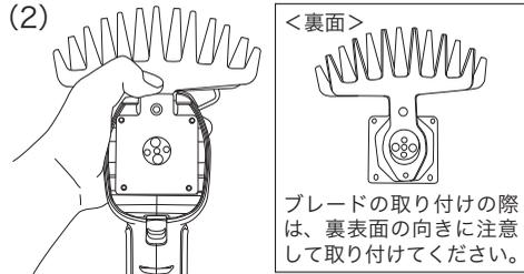
ブレードの取り付けの際は、裏表面の向きに注意して取り付けてください。
