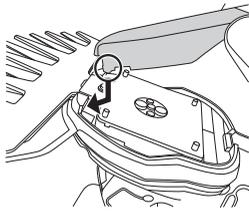
図 (2) のようにブレードを支えたまま、ブレードカバー左右のツメを本体に引っかけるように置いてください。
