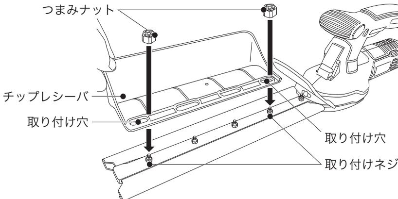
取り付けは、チップレシーバの取り付け穴を庭木バリカンの取り付けネジ2本に合わせ、つまみナットで仮締めを行ってください。ブレードカバーを取り外した後、しっかりとつまみナットを締め付け固定してください。
