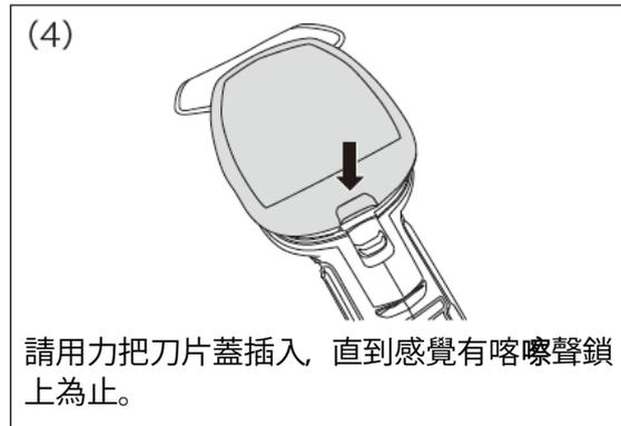
刀片的卸除如圖 (1) 般，拆下刀片蓋，卸下修草機刀片之後，請如圖 (4) 般裝回刀片蓋。
