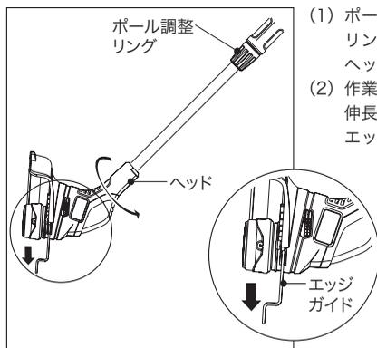
(1) ポール調整リングをゆるめ、ヘッドを矢印の方向に回転させ、ポール調整
