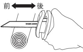
作業を行う際は、左のイラストのようにマルチのこぎりヘッド部分を握りながら切断することで振動が軽減されます。
