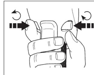
左図の方向から見て、正/逆転ロックスイッチを左側から一杯に押すと正転します。ロックスイッチを右側から一杯に押すと逆転します。このスイッチを中央位置にセットしておくと、トリガースイッチがロックされて動かなくなります。使用しないときは、ロックをかけた状態にしておいてください。
