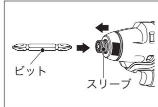
スリーブを矢印の方向に引きビットを差し込み、スリーブを放してください。
