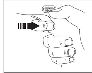
左図のように、トリガー（引き金）スイッチを引くと作動します。またトリガースイッチを放せば止まります。トリガースイッチには無段変速機能が組み込まれていますので、強く引くと高速、弱く引くと低速というように速度を調節できます。作業の内容に合わせてトリガーの引き具合で速度を調節できるので大変便利です。
