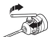
備え付けのチャックキーをドリルチャックにある3ヶ所の穴に順々に入れ、反時計回りにまわしてアクセサリー挿入口をゆるめてください。ドリルチャックに先端工具を奥まで差し込んでください。チャックキーをドリルチャックにある3ヶ所の穴に順々に入れ、時計回りにまわしてアクセサリー挿入口をしっかりと締めてください。
