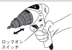
左図のように、トリガースイッチを引くと作動します。またトリガースイッチを放せば止まります。トリガースイッチを引いた状態でロックオンスイッチを押すと、トリガースイッチがロックされ継続的に使用されるときに便利です。ロックを解除するには、トリガースイッチをもう一度軽く引いてください。
