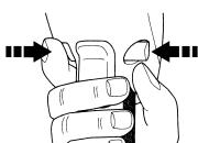
左図の方向から見て、正転／ロック／逆転スイッチを左側から一杯に押すと正転します。スイッチを右側から一杯に押すと逆転します。このスイッチを中央位置にセットしておくと、トリガースイッチがロックされて動かなくなります。使用しないときは、ロックをかけた状態にしておいてください。
