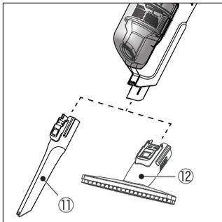
ハンディ用隙間ノズル (⑪) 及びハンディ用ブラシノズル (⑫) は本体の先端に差し込んでご使用ください。ハンディ用隙間ノズルは狭い隙間の掃除、ハンディ用ブラシノズルは細かいゴミを掻きだす掃除に便利です。
