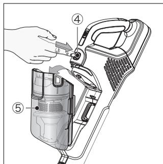
本体にあるダストケース取り外しボタン (4) を押すとダストケース (5) が図のように取り外せます。
