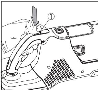
電源ボタン (1) を押してください。バッテリー残量ランプが点灯し、製品が作動します。
