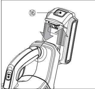
(1) スライド式バッテリーを本製品に取り付けるには、この製品の握り部分の下にある挿入口に前方からバッテリーを後方にスライドさせ「カチッ」としっかりはまるまでバッテリーを差し込んでください。
