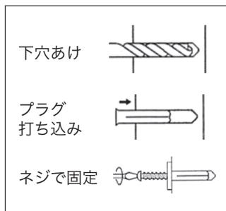
アンカープラグ（無色透明の部品）はホルダーをコンクリートの壁に固定する時にご利用いただけます。
