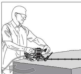
図のように、電源コードが常に本体の後ろにくるように、本体から遠ざけてください。
