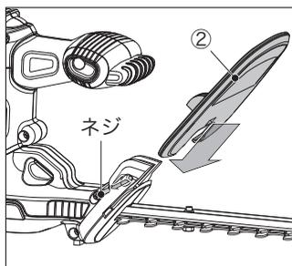
左図のようにネジがついていますので一度ドライバーで外してください。
