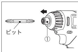
ビットを取り付けるには、スリーブ（①）を矢印の方向に引きながら、インパクトドライバー用ビットを差し込んでください。奥まで差し込んだ後、スリーブから手を放してビットを固定します。
