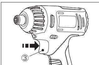
左図のように、無段変速トリガースイッチ（③）を引くと作動します。またトリガースイッチを放せば止まります。トリガースイッチには無段変速機能が組み込まれていますので、深く引くと高速、浅く引くと低速というように速度を調節できます。作業の内容に合わせてトリガーの引き具合で速度を調節できるので大変便利です。
