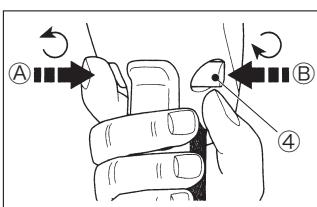
左図の方向から見て、正転／ロック／逆転スイッチ（④）をⒶから一杯に押すと正転します。スイッチをⒷから一杯に押すと逆転します。このスイッチを中央位置にセットしておくと、トリガースイッチがロックされて動かなくなります。使用しないときは、ロックをかけた状態にしておいてください。このスイッチの位置を替えるときは、必ずトリガースイッチを放してください。
