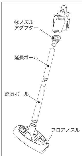
本体にノズルアダプター⑭を接続し、左図のように、延長ポール2本とフロアノズルをしっかり接続してください。
