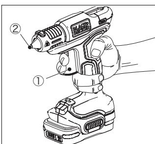
(2) トリガー (①) をゆっくり引くと、ノズル (②) より引いた分のグレーが出てきます。グレーは接着する材料の一方のみに塗ってください。
