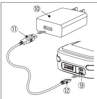
(1) 充電池のmicroUSB-B入力ポート（⑨）に、USBケーブルのmicroUSB-Bプラグ（⑫）を接続してください。
