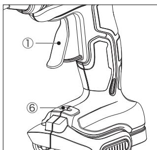
(2) 電源をオンにすると、内部のヒーターが予熱を開始します。予熱中はインジケーター (⑥) が点滅してお知らせします。約60秒で予熱は完了し、インジケーターは点灯に変わります。予熱が完了するまでトリガー (①) には触れないようにしてください。
