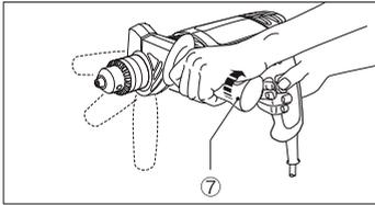
サイドハンドル(⑦)の握りの部分をゆるめた後、本機の先端側から差し込んでください。作業に合った角度に合わせて、握り部分をしっかりと締め付けてください。
