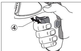
正転/逆転切換スイッチ(④)を工具左側にスライドさせると正転します。正転/逆転切換スイッチを工具右側にスライドさせると逆転します。
