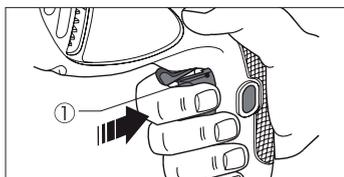
左図のように、トリガースイッチ(①)を引くと作動します。またトリガースイッチを放せば止まります。トリガースイッチには無段変速機能が組み込まれていますので、強く引くと高速、弱く引くと低速というように速度を調節できます。作業の内容によってトリガースイッチの引き具合で速度を調節できるので大変便利です。
