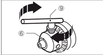
備え付けのチャックキー(⑨)をキー式チャック(⑥)にある3カ所の穴に順々に入れ、反時計回りにまわしてアクセサリ挿入口をゆるめてください。ドリルチャックに先端工具を奥まで差し込んでください。チャックキーをドリルチャックにある3カ所の穴に順々に入れ、時計回りにまわしてアクセサリ挿入口をしっかりと締めてください。このとき、1ヶ所だけで締め付けず、3ヶ所の穴を順々に均等に締め付けてください。
