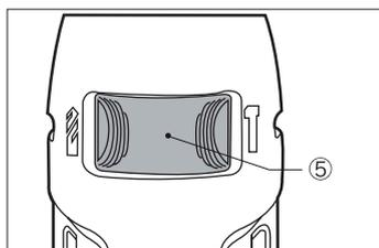
金工/木工穴あけ作業にはドリル/振動ドリル切換スイッチを(⑤)“**D**”(ドリル)の位置にセットしてください。コンクリートへの穴あけ作業には、切換えスイッチを“**T**”(振動ドリル)の位置にセットしてください。
