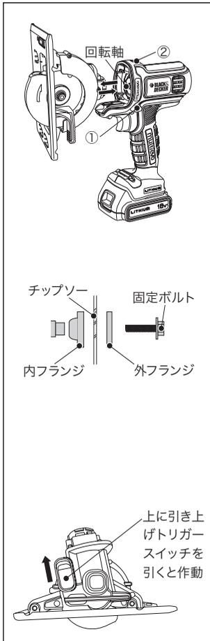
**!** トリガースイッチを切り、バッテリーを必ず本体から外した状態で作業を行ってください。
