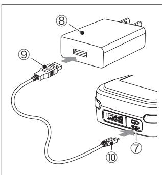
(1) 充電池のmicroUSB-B入力ポート（⑦）に、USBケーブルのmicroUSB-Bプラグ（⑩）を接続してください。
