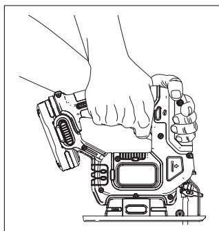
切断作業を行う際は、一方の手で本製品の握り部を持ち、もう一方の手で左の図のように本製品の前面をしっかりと押さえるように持ってください。
