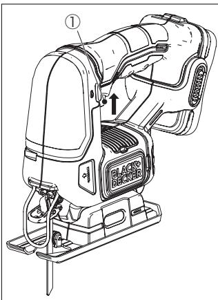
(2) ロックを解除した状態で無段変速トリガースイッチ (①) を引くと作動します。また無段変速トリガースイッチを放せば止まります。無段変速トリガースイッチは、トリガーの引き加減でストローク数を0～2,800回／分に調節することができます。トリガーをいっぱいに引いた状態で最大ストローク数となります。
