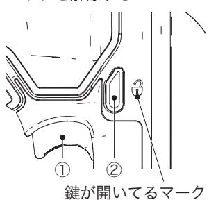
(1) 製品を作動させるにはロックを解除する必要があります。ロックボタン (②) を左のイラストの方向 (鍵が開いてるマークがある側) から押し込み、ロックを解除してください。
