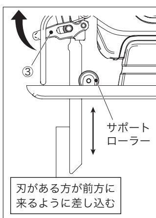
本機は、Uシャンクタイプ(□)とTシャンクタイプ(△)の両方のジグソーブレードを装着することができます。
