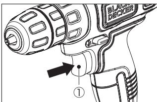
左図のように、無段变速トリガースイッチ（①）を引くと作動します。またトリガースイッチを放せば止まります。トリガースイッチには無段变速機能が組み込まれていますので、深く引くと高速、浅く引くと低速というように速度を調節できます。作業の内容に合わせてトリガーの引き具合で速度を調節できるので大変便利です。
