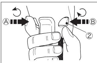
左図の方向から見て、正転／ロック／逆転スイッチ（②）をⒶから一杯に押すと正転します。スイッチをⒷから一杯に押すと逆転します。このスイッチを中央位置にセットしておくと、トリガースイッチがロックされて動かなくなります。使用しないときは、ロックをかけた状態にしておいてください。このスイッチの位置を替えるときは、必ずトリガースイッチを放してください。
