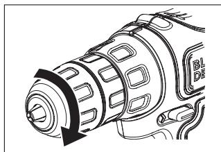
(2) チャックカバー後半部を押さえながら、前半部を時計回りに回してキーレスチャックを締めてください。キーレスチャックの3本の爪がビットを挟み込み、固定します。
