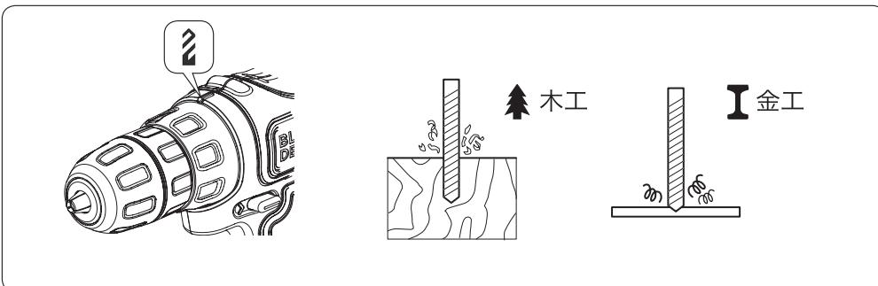
穴あけ作業には、11段階目のクラッチポジション“”の位置にクラッチをセットしてください。この位置ではトルク調整装置が作動しません。
