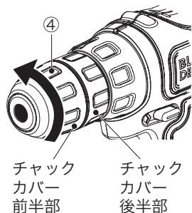
(1) 本製品にはキーレスチャック(4)が装備されています。チャックカバー後半部を押さえながら、前半部を反時計回りに回してチャックを開いてください。使用するビットを開いたチャックの中に20ミリ程度押し込んでください。
